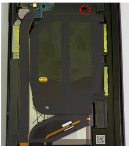
Lors de la fixation de l'antenne MST, veillez à ce que celle-ci s'adapte à la forme de l'appareil.
