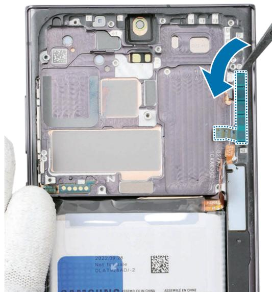
6 Retirez l'antenne 5G mmWave supérieure.
