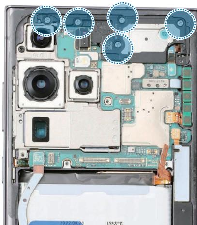
9 Raccordez le câble d'interconnexion à la carte mère et au châssis.
