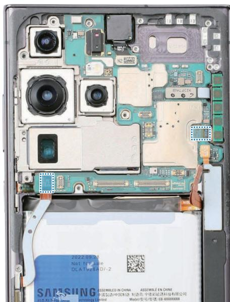
5 Repérez la vis noire 3489 (1 unité) et fixez-la sur le bloc d'objectifs à l'aide d'un tournevis cruciforme.
