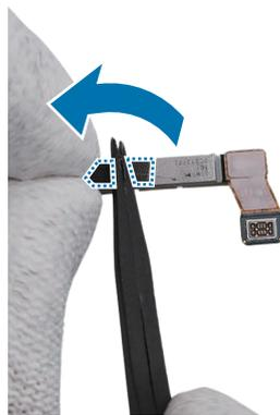
2 Enlevez le film transparent du nouvel adhésif et appliquez-le sur la partie inférieure de l'antenne, avec l'extrémité arrondie la plus éloignée du connecteur.
