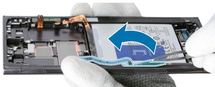
3 Retirez le module d'antenne 5G mmWave inférieur.
