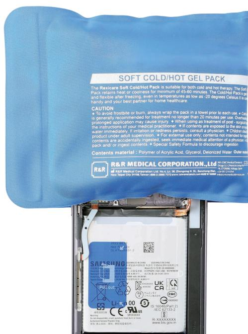
2 Avant que le coussinet thermique ne refroidisse, servez-vous de l'aiguille d'éjection du compartiment pour carte SIM pour éliminer la mousse collée entre l'objectif avant et le module d'écran.
