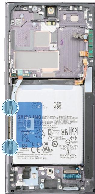
2 Insérez l'extrémité pointue de la pincette plastique dans l'espace entre la monture à vis inférieure du support d'antenne 5G mmWave gauche et le châssis.
