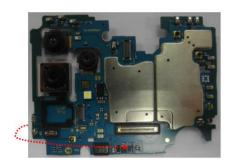
L'objectif arrière est fixé au module de la carte mère, et il doit être débranché via le connecteur au dos de la carte mère.
